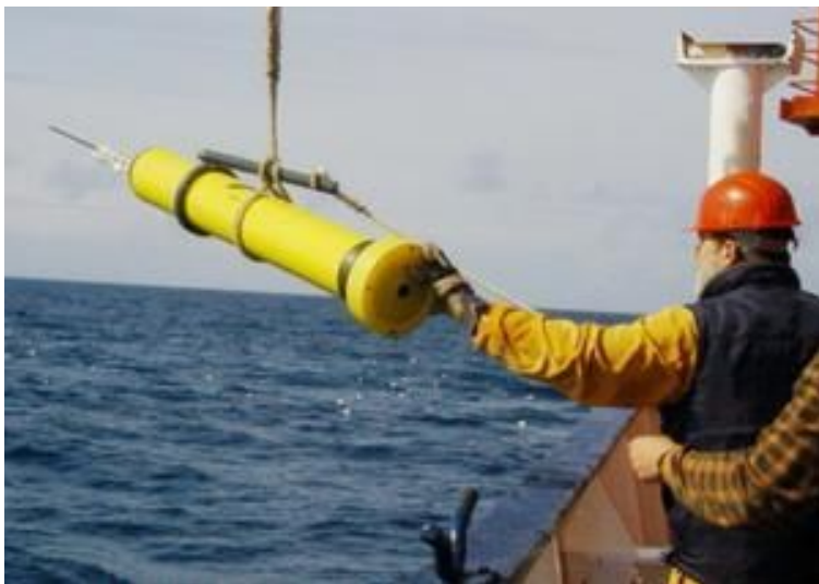
Obr. 1: Hlbinná sonda Argo spúšťaná z výskumnej lode
